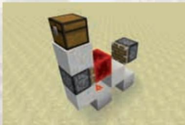
nenden Geheimgangs (siehe Seite 30 ff.). Der Mechanismus, der den Boden unter den Füßen des Spielers wegzieht, kann auch auf einer weiteren Energiequelle beruhen. Platziert dazu eine Redstonefackel, die die Kolben standardmäßig aktiviert. Sobald die Truhe geöffnet wird, schaltet das nun erzeugte Signal die Fackel aus. Die Kolben ziehen sich zusammen und der Spieler fällt ins Loch.
