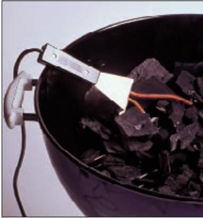
*Die Schlaufe des elektrischen Anzünders wird zwischen die im Grill angehäufte Holzkohle gesteckt. Sobald das Gerät an den Strom angeschlossen ist, beginnt es rot zu glühen. Nach 2-3 Minuten brennen die ersten Kohlen. Wenn ein Großteil der Kohlen brennt, nach etwa 10-15 Minuten, das Gerät herausnehmen.*
